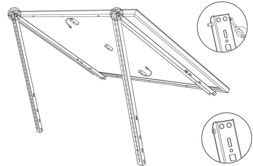
4. Montieren Sie den unteren Tragarm und stellen Sie den Winkel so ein, dass die maximale Sonneneinstrahlung erreicht wird.
