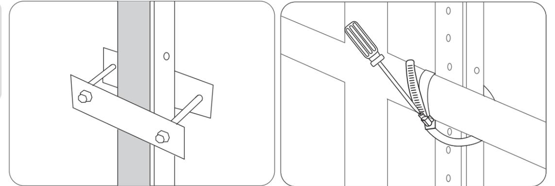
9. Befestigen Sie den Mikrowechselrichter mit Edelstahl-Sechskantmutter mit Flansch am Balkongeländer.
