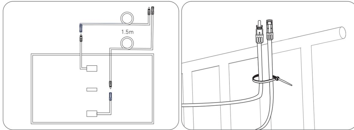
8. Befestigen Sie das Montagehilfsseil an der Halterung und am Balkongeländer. Stellen Sie sicher, dass das Seil straff gespannt ist.
