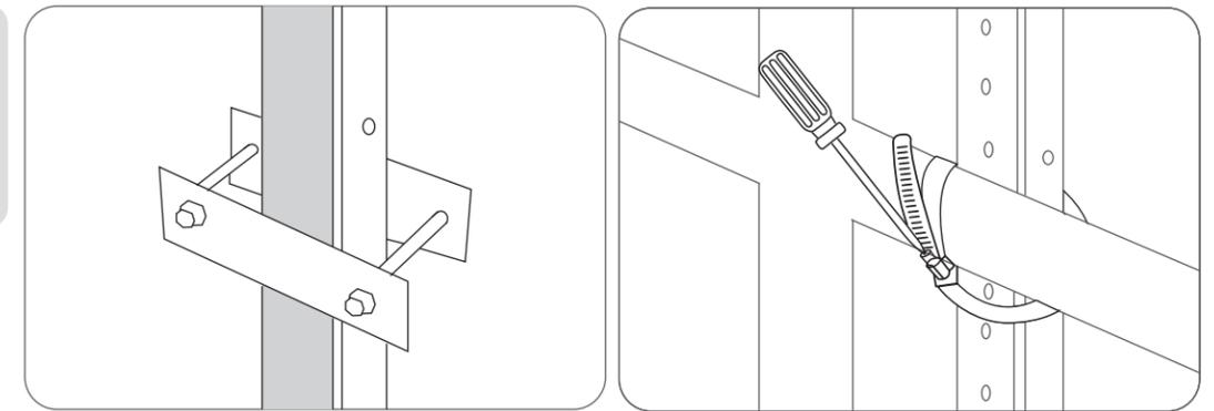
11. Befestigen Sie den Mikrowechselrichter mit Edelstahl-Sechskantmutter mit Flansch am Balkongeländer.
