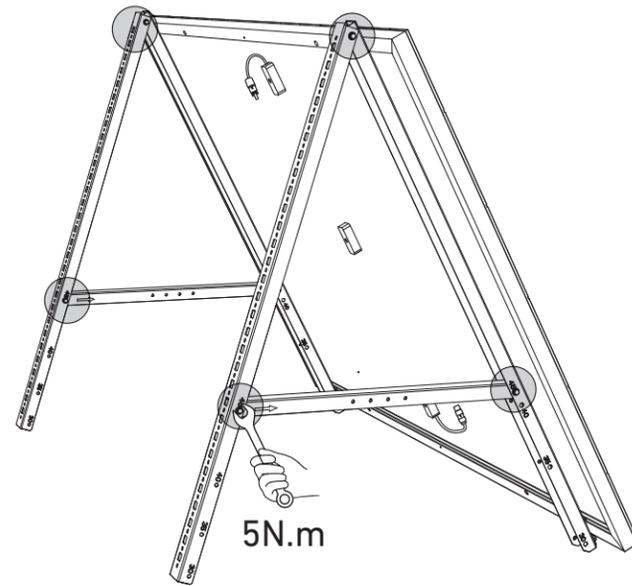
6. Verbinden Sie das Solarpanel mit dem Verlängerungskabel des Solarpanels.
