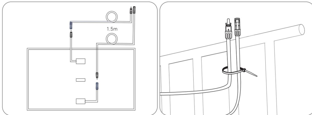
7. Befestigen Sie das Montagehilfsseil an der Halterung und am Balkongeländer. Stellen Sie sicher, dass das Seil straff gespannt ist.
