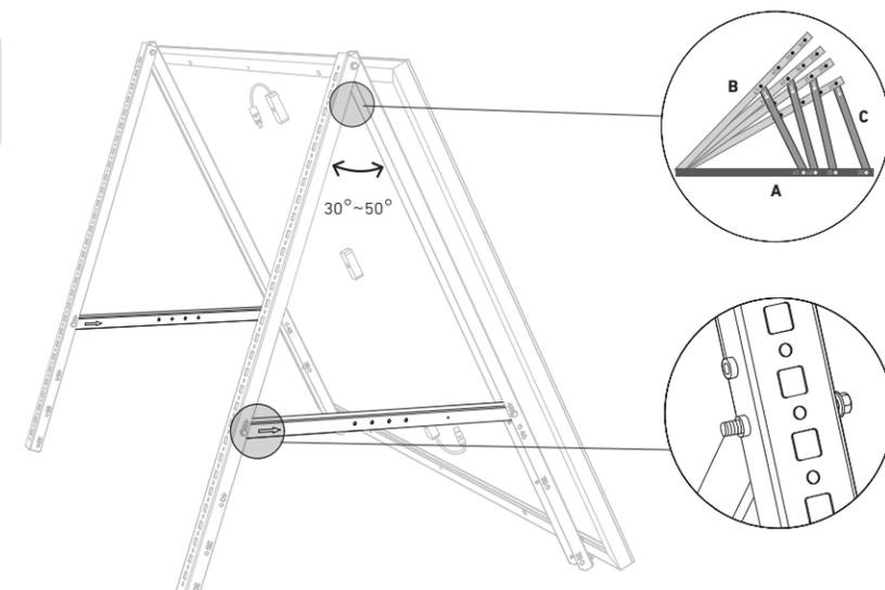
5. Ziehen Sie alle Schrauben mit einem Drehmoment von 5 Nm an.
