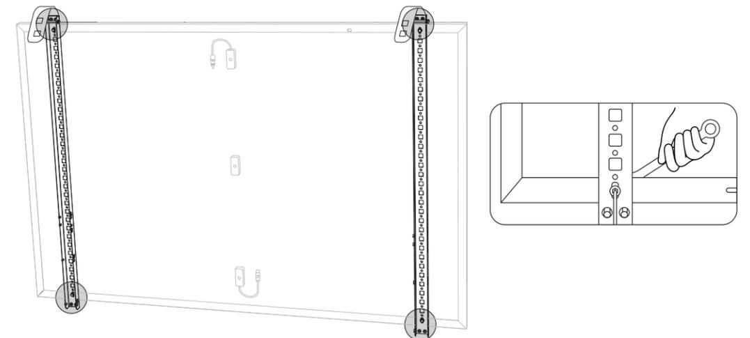
4. Ziehen Sie alle Schrauben mit einem Drehmoment von 5 Nm an.
