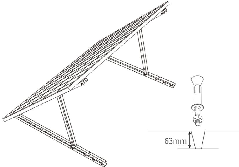
7. Ziehen Sie alle Schrauben mit einem Drehmoment von 5 Nm an.
