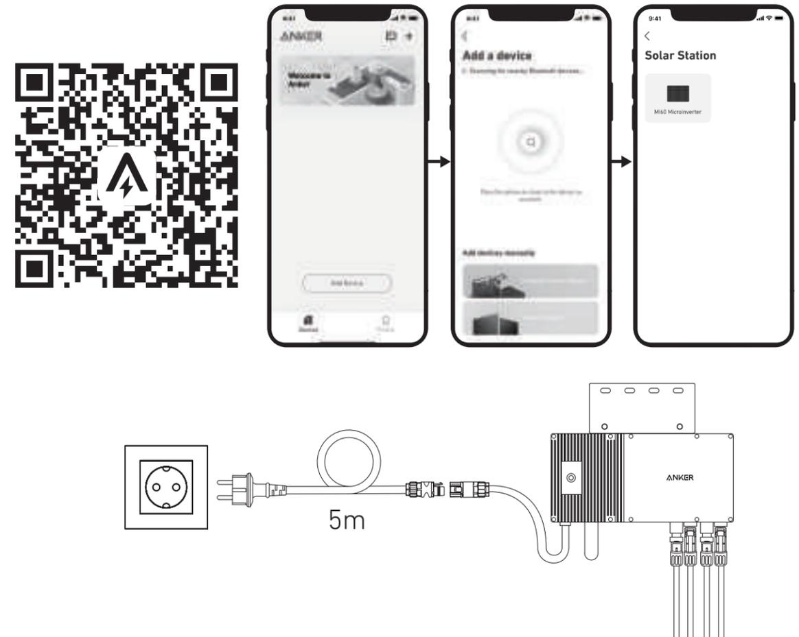
14. Laden Sie die App herunter und befolgen Sie die Anweisungen in der App, um die Konfiguration des Mikrowechselrichters und den Anschluss des Schuko-Kabels abzuschließen.
