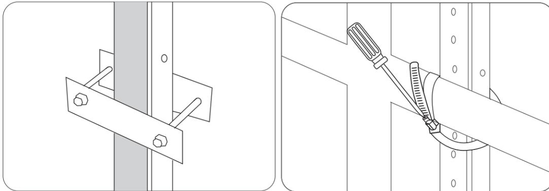
7. Befestigen Sie den Mikrowechselrichter mit Edelstahl-Sechskantmutter mit Flansch am Balkongeländer.
