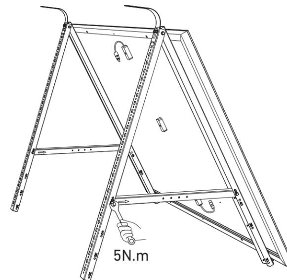
7. Verbinden Sie das Solarpanel mit dem Verlängerungskabel des Solarpanels.
