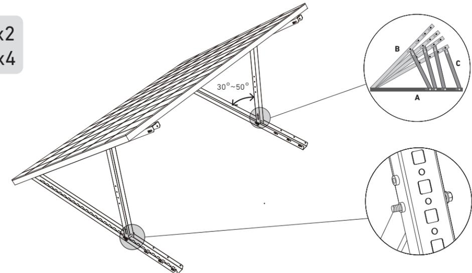
5. Richten Sie das Solarpanel an den Löchern des vertikalen Gerüsts aus, um vier Befestigungspunkte zu markieren. Die Montagepunkte auf demselben vertikalen Traggerüst sollten 800 mm (31,4 Zoll) voneinander entfernt sein.
