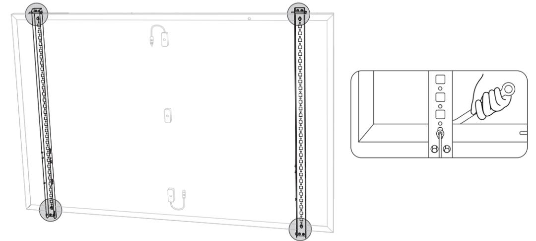
3. Montieren Sie das vertikale Gerüst und den Solarpanel-Tragarm, ohne die Schrauben festzuziehen.
