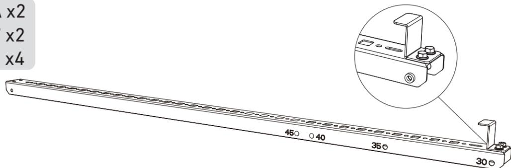
2. Legen Sie die Silikon-Pufferkissen auf die U-förmigen Träger. Befestigen Sie dann die U-förmigen Träger am Solarpanel-Tragarm.
