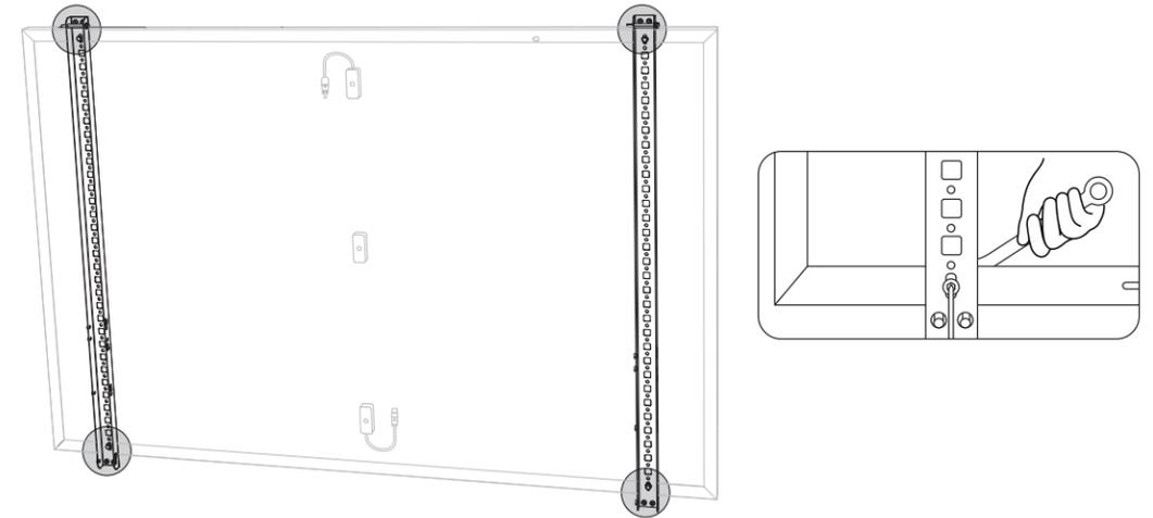
3. Ziehen Sie alle Schrauben mit einem Drehmoment von 5 Nm an.
