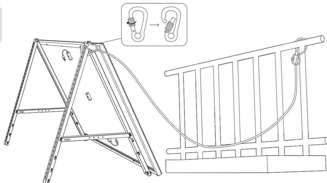
8. Bringen Sie die Halterungen für das Solarpanel am Balkongeländer an und befestigen Sie sie dann mit Befestigungsklemmen und Edelstahl-Sechskantmutter mit Flansch.
