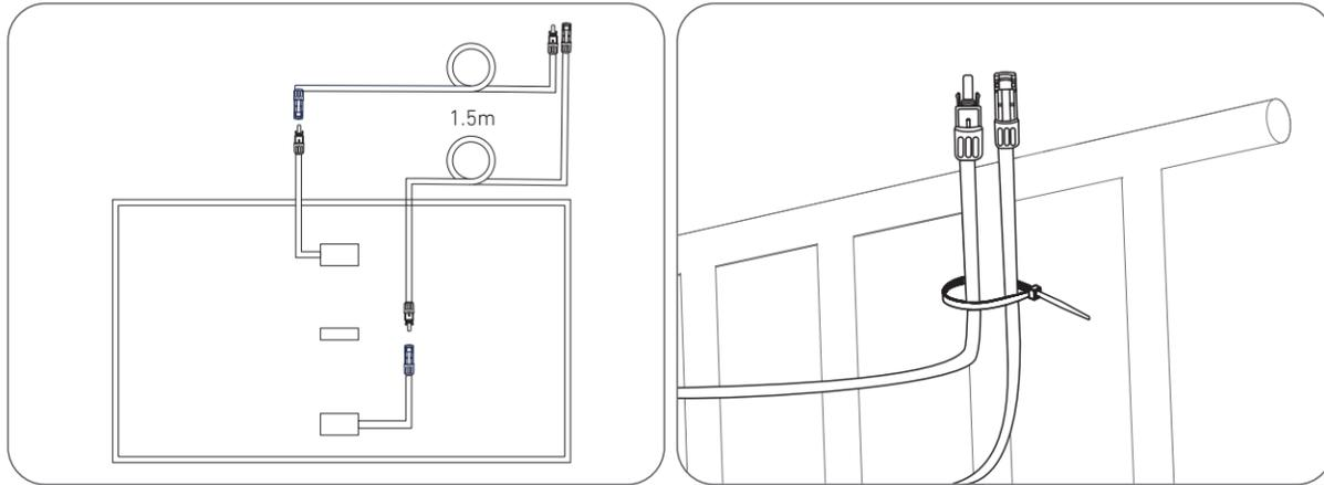
6. Befestigen Sie das Montagehilfsseil an der Halterung und am Balkongeländer. Stellen Sie sicher, dass das Seil straff gespannt ist.
